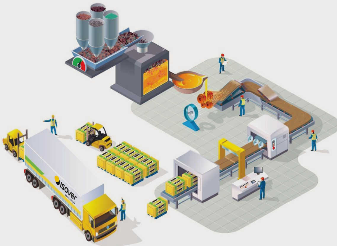
Obr. 3 - Schéma výroby minerální vlny
