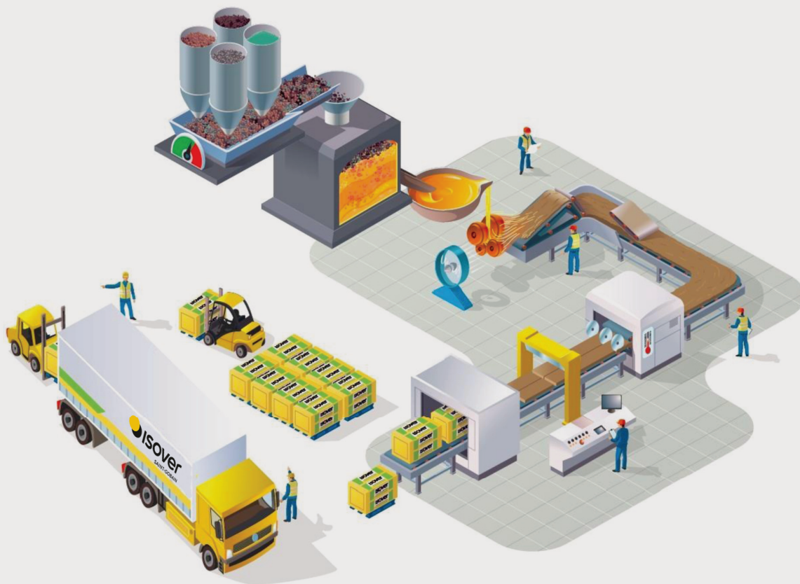
Obr. 3 - Schéma výroby minerální vlny
