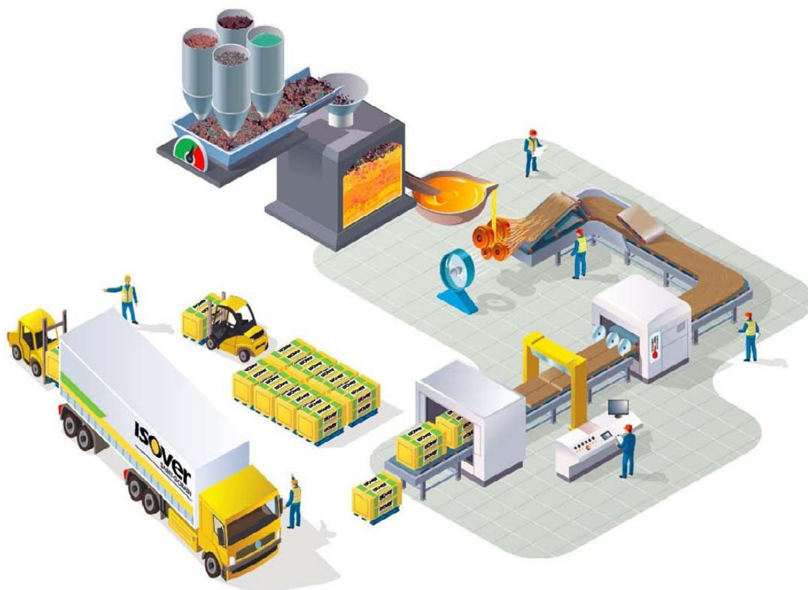
Obr. 3 – Schéma výroby minerální vlny
